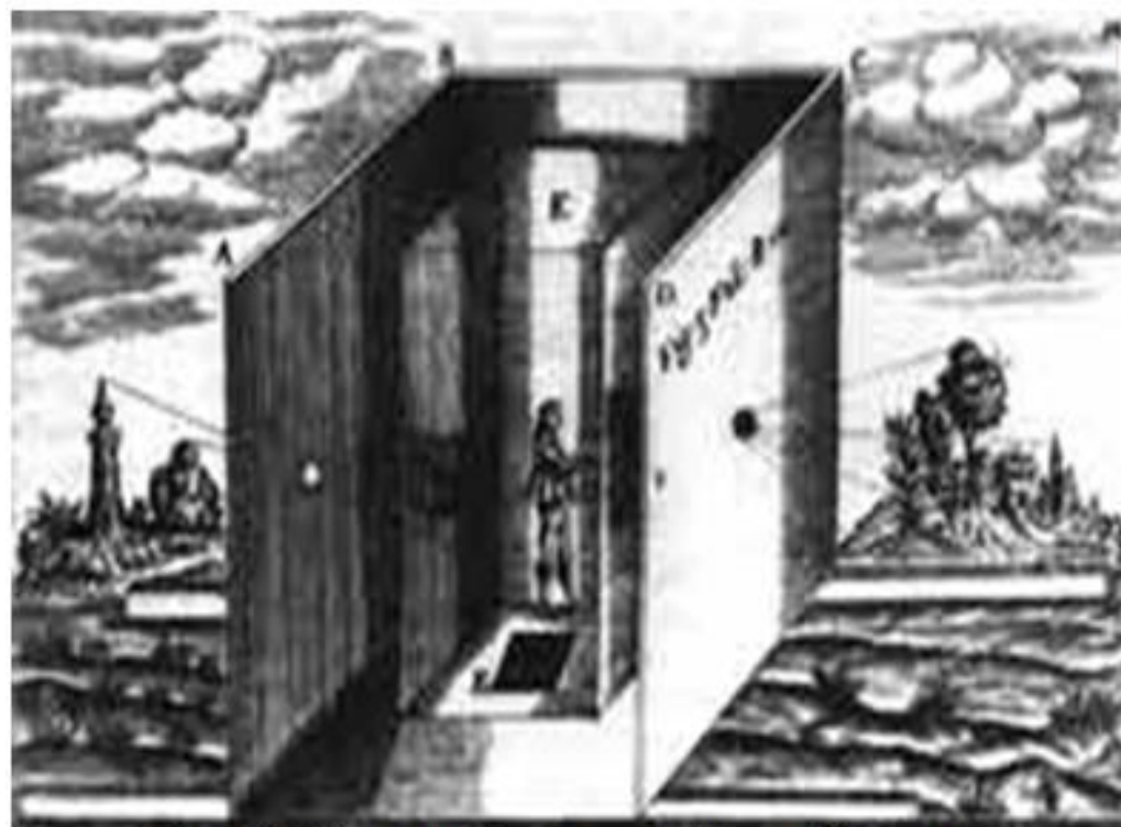
Ryc. 13. Pierwotny aparat fotograficzny - camera obscura
